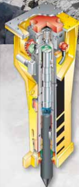
Sección transversal de un martillo hidráulico mostrando el mecanismo percutor, que genera la fuerza de demolición.
